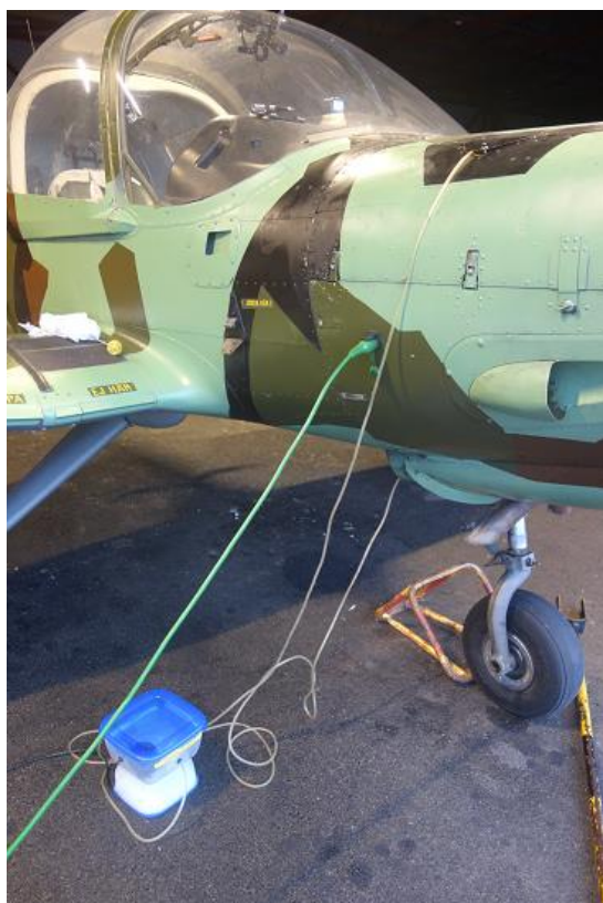
Motorvärme och motoravfuktare anslutna.
